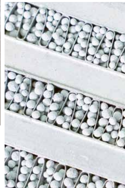
Zeolith-Granulat kann als Langzeit-Wärmespeicher dienen.
