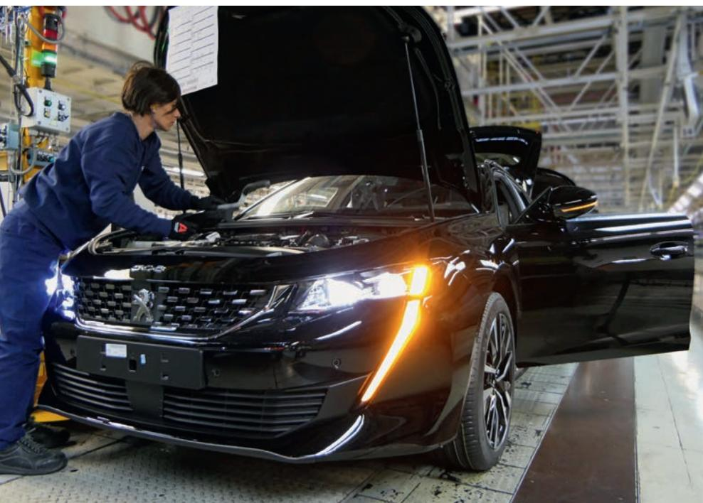
Das Werk Mulhouse des PSA-Konzerns arbeitet nach dem sogenannten Monoflux-Prinzip. Es kann gleichzeitig Autos verschiedener Marken in beliebiger Konfiguration herstellen, egal ob Stromer oder Verbrenner. Dafür musste das Innere der Fabrik praktisch komplett neu gebaut werden.
