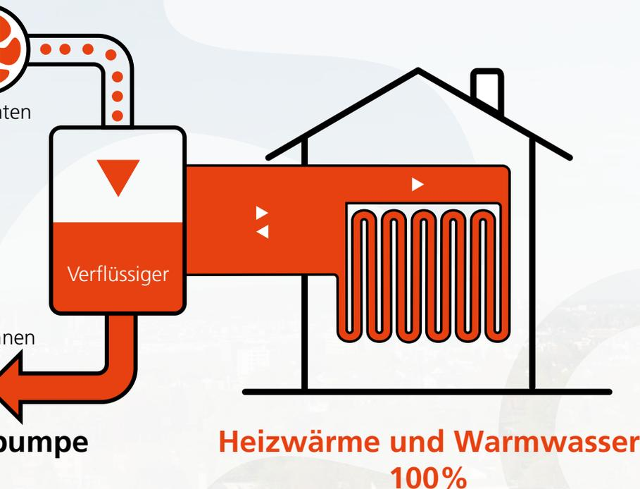
höheres Temperaturniveau, wodurch es mithilfe eines weiteren Wärmeübertragers (Verflüssigers) für das Heizsystem oder die Warmwasserzubereitung nutzbar gemacht werden kann.
